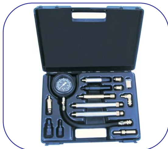
KP 80/5 Zestaw do sprawdzania ciśnienia sprężania w silnikach benzynowych i wysokoprężnych (0 - 40 bar), zawiera 13 adapterów do silników benzynowych i wysokoprężnych.
