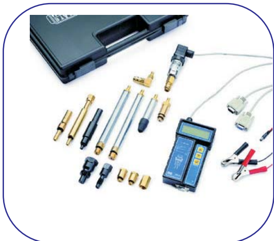
KPD 01 uniwersalny miernik ciśnienia sprężania z wyświetlaczem cyfrowym, zakres pomiarowy 0..60 bar, rozdzielczość 0,1 bar, w zestawie 12 adapterów do silników benzynowych i wysokoprężnych.
