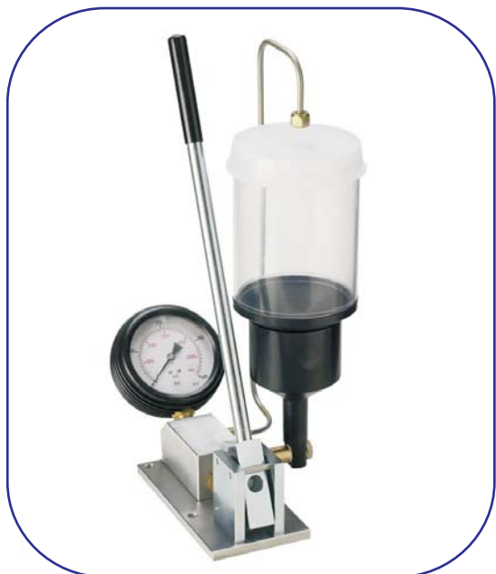
DET 061 Próbnik wtryskiwaczy do silników wysoko- prężnych (obieg zamknięty., manometr 100 mm, zakr. 0-400 bar, z dodatkową wskazówką wleczoną).
