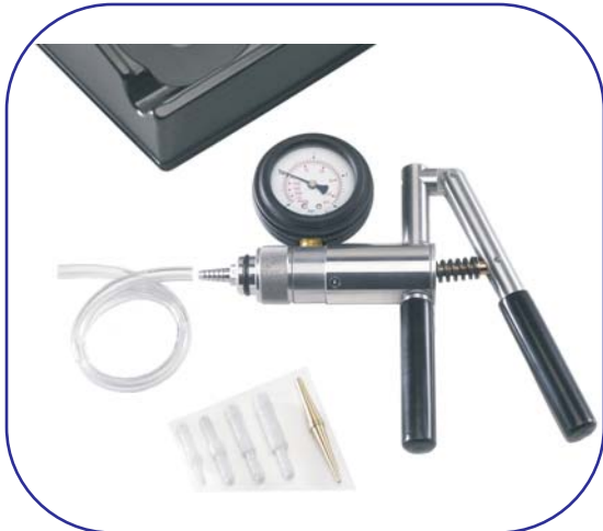
HV 90 Uniwersalna pompka podciśnieniowo-ciśnieniowa, wykonanie metalowe, zakres od -0,8 do +3 bar. W zestawie dwustronny adapter mosiężny, cztery adaptory plastikowe oraz wężyk.
