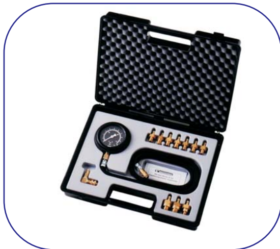
OP 85 Zestaw do kontroli ciśnienia oleju w silnikach spalinowych (10 adapterów obejmujących większość producentów + adapter kątowy).
