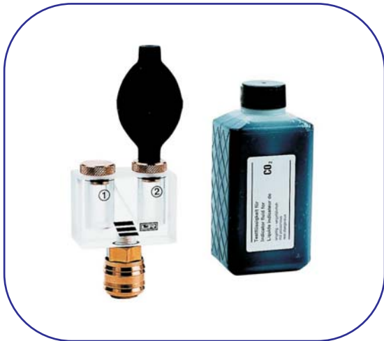
LT 200.2 Tester uszczelki podgłowicowej (wykrywanie przedmuchiów spalin do układu chłodzenia bez konieczności demontażu głowicy) - możliwość mocowania na stożkach gumowych.
