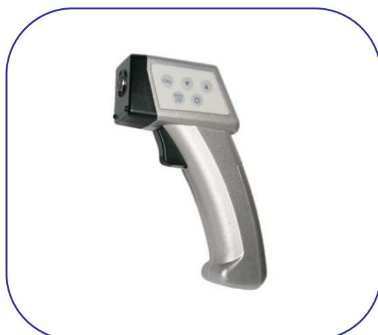
CTG 01 Elektroniczny tester grubości powłoki na podłożach metalowych ferromagnetycznych (zakres 1 do 1000 um), wersja CTG 03 pozwala wykonywać pomiary również na podłożach metalowych nie ferromagnetycznych (miedź, itp.)
