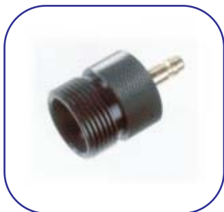
Adapter typu KS.. do sprawdzania działania korka chłodziwa (zbiorniczka wyrównawczego) - szczelność korka, oraz ciśnienie otwarcia w powiązaniu z testerem TVU139/1s
