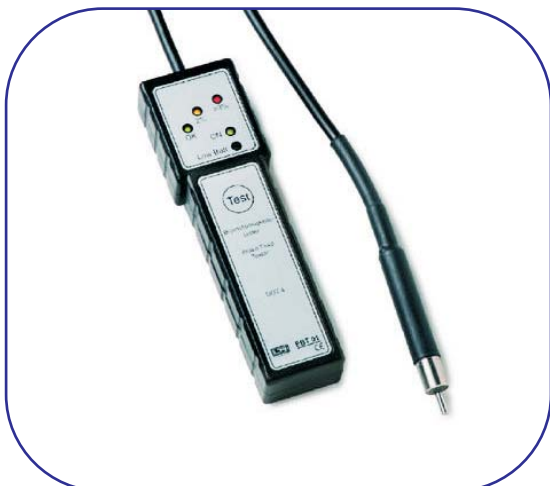
EBT 01 Elektroniczne tester płynu hamulcowego DOT 4 , procentowa zawartość wody pokazywana jest przez 3 diody LCD, dodatkowa dioda sygnalizuje spadek napięcia baterii.
