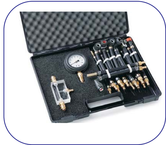
LR 180_AK2 zestaw do sprawdzania ciśnienia/podciśnienia w samochodowych systemach paliwowych po stronie zasilania oraz na powrocie. (manometr NG 63 o zakresie -1...+9 bar).
