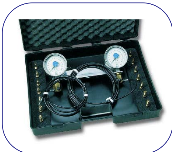
BDP 04 Zestaw do kontroli hamulców hydraulicznych (2 x manometr 0 do 160 bar, 1 x przewód wysokociśnieniowy o dł. 2 m, 1 x przewód wysokociśnieniowy o dł 5 m., 7 rodzajów adapterów po 2 szt).
