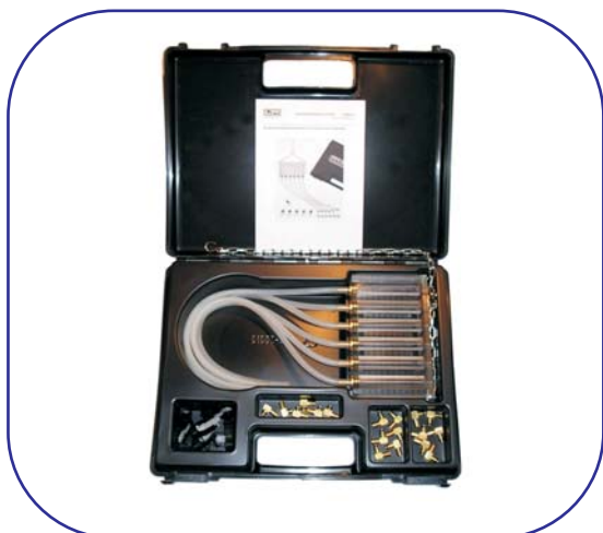
CRMK 01 Zestaw do sprawdzania wtryskiwaczy elektromagnetycznych common rail na podstawie ilości paliwa na powrocie (w komplecie adaptery Bosch, Delphi, Denso i VDO/Siemens).
